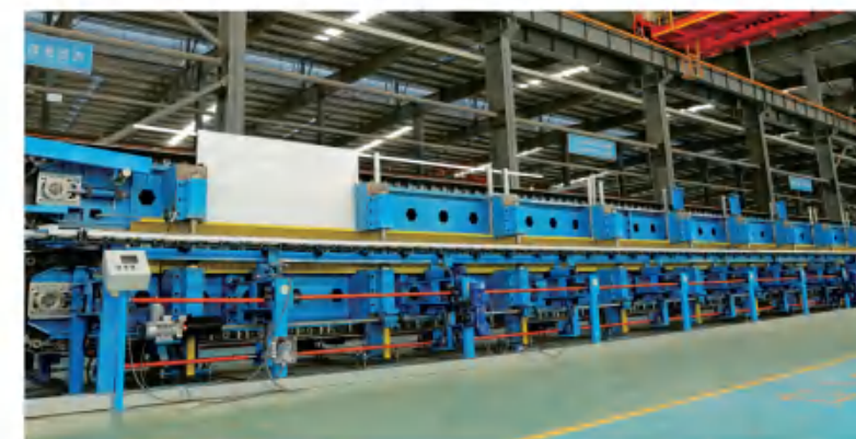
双履带热成型机 Double belt thermal pressing machine
